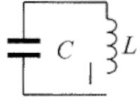
$\begin{cases} q(t) = q_{\max} \sin(\omega t + \varphi_0) \\ I(t) = q'_t = \omega q_{\max} \cos(\omega t + \varphi_0) = I_{\max} \cos(\omega t + \varphi_0) \end{cases}$ <p>Формула Томсона: <math>T = 2\pi\sqrt{LC}</math>, откуда <math>\omega = \frac{2\pi}{T} = \frac{1}{\sqrt{LC}}</math>.</p> <p>Связь амплитуды заряда конденсатора с амплитудой силы тока при свободных электромагнитных колебаниях в идеальном колебательном контуре: <math>q_{\max} = \frac{I_{\max}}{\omega}</math></p> |
